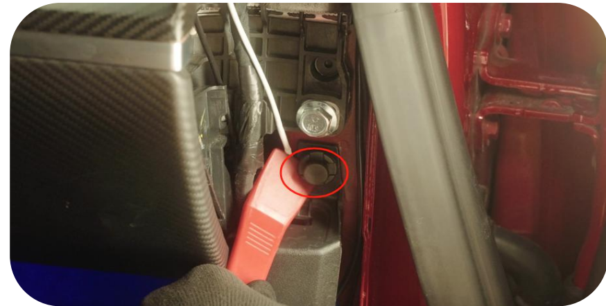
16. Remove the door sill side panel clips
